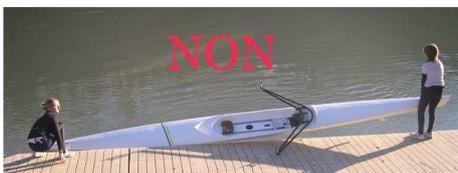
**ATTENTION À NE PAS COGNER LA DÉRIVE :** si la dérive est tordue, le bateau ira de travers. Pour éviter cela, il faut s'avancer bien au bord du ponton, placer l'avant du pied un peu au-delà du bord, poser le bateau en l'écartant du bord du ponton.
